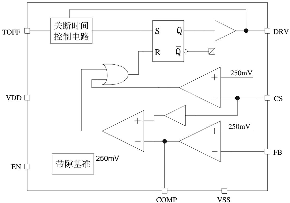
图 2: QX5305 的内部电路方框图
