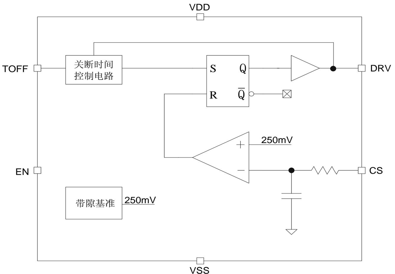
图 2: QX9920 内部电路方框图
