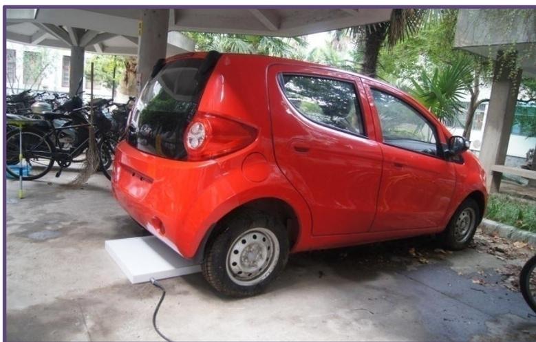
东南大学课题组研制：国内首套电磁谐振式电动汽车无线充电系统。
