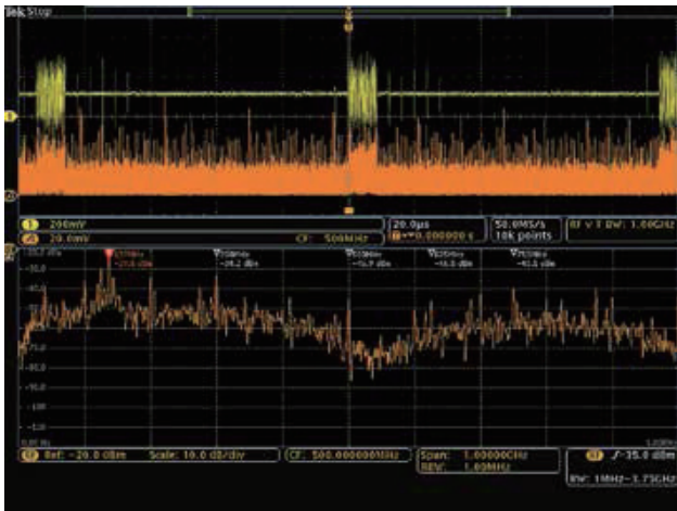
图 13. 在示波器其中一条通道上使用无源探头探测信号，发现与 RF 相关的信号。
