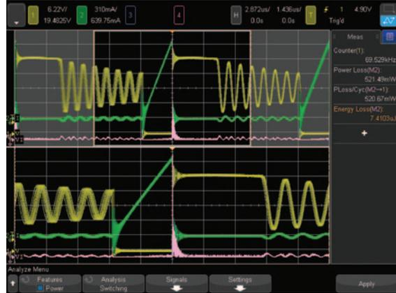
图 1. 通过测量开关损耗和传导功率损耗，您可以表征开关电源的瞬时功耗。
