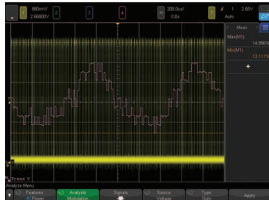
图 5. 绘制 PWM 信号在一段较长时间内打开或关闭时的内嵌变化图形，可以显示反馈环路系统的控制环路响应。
