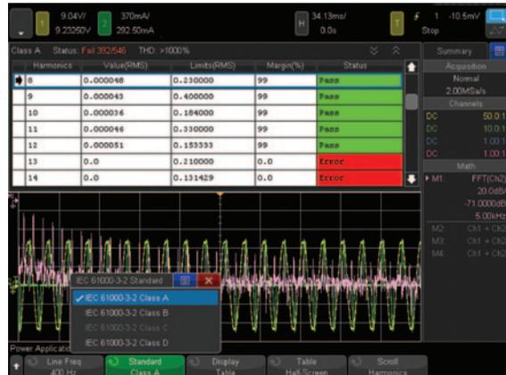
图 2. 根据 IEC 61000-3-2 标准执行预先一致性线路谐波测试。此屏幕显示了多达 40 个谐波。
