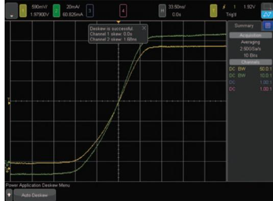
图 12. 为了执行精确的功率测量和计算，必须校正电压和电流探头之间的时延，这一点极其重要。
