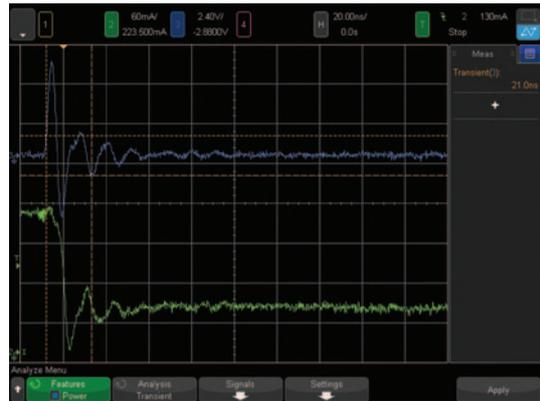
图 8. 此分析模块测量了直流输出的负载瞬时响应, 即负载变化时直流输出变成稳定状态所用的时间。
