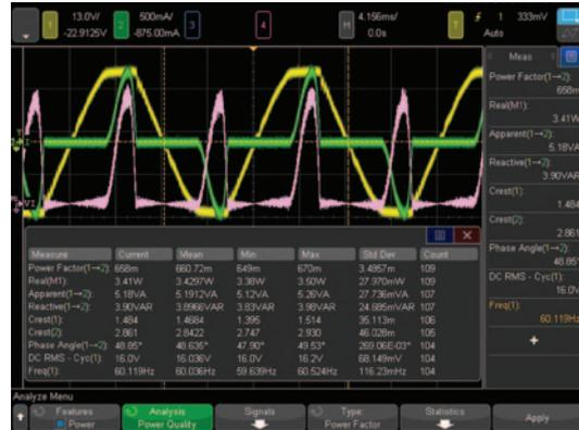
图 4. DSOX3PWR 电源测量选件提供以下电源质量测量的结果表格：功率因数、有效功率、视在功率、无功功率、波峰因数和相位角。
