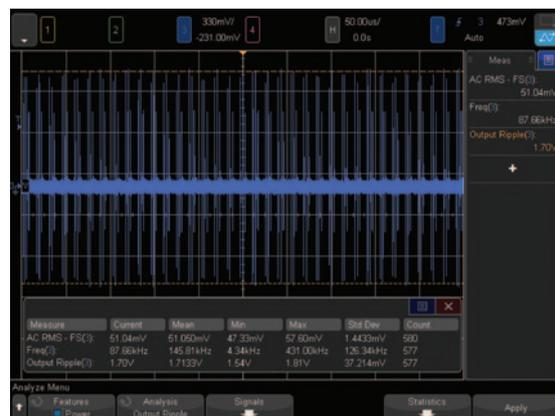
图 6. 输出分析能够表征输出直流电压的纹波成分（输入线路或者 MOSFET 管开关引起）。
