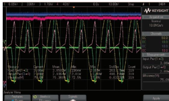
图 11. 效率分析能够测试电源的整体效率。
