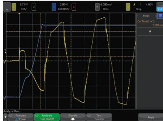
图 7. 开机时间分析测量了施加输入电压后电源输出电压变成稳定状态所用的时间。
