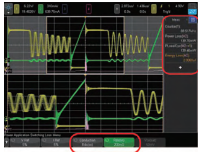
图 17: 根据 R_{ds(on)} 输入值测量一个开关周期的功率和能量损耗。
