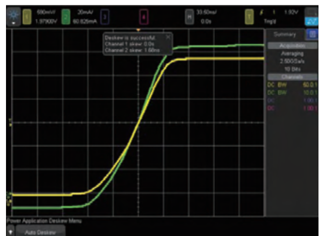
图7: 完成电压探头和电流探头间自动偏移校正之后的偏移校正显示。
