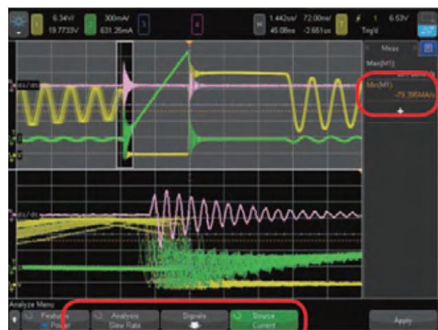
图 23: 晶体管启动相的电流波形斜率测量。
