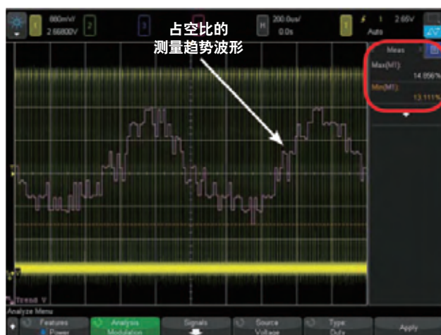
图 25: 开关晶体管选通输入的占空比调制测量。
