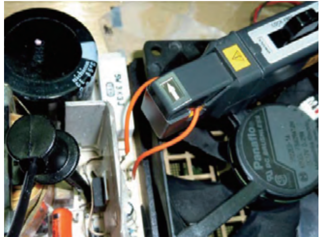
图 4: 在电源中创建特定的电流环路，以测量电流。
