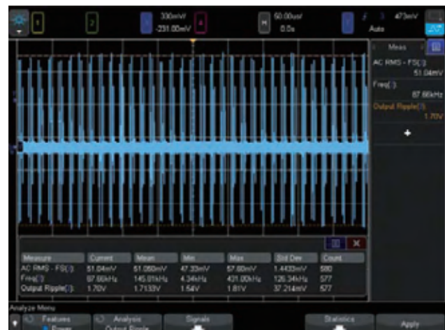
图 28: 直流输出信号的输出纹波测量。
