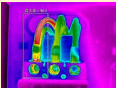
电气线缆过载三相不平衡
