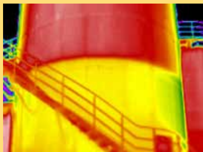
对储罐液位线进行快速二次校验
