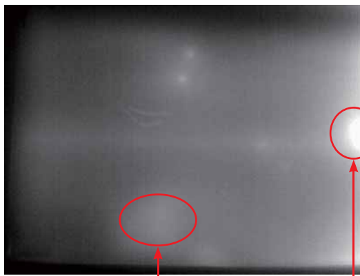
此处为液晶屏反射检测人员的辐射能量所致，需要尽量避开或遮挡。
