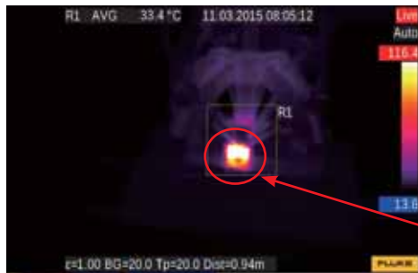
TIK1000+ 微距镜头 3 在离目标 90 cm 进行检测。
