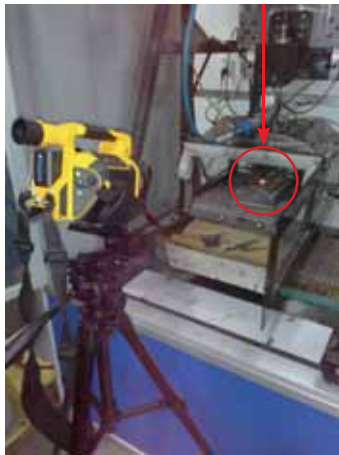
TIK1000+ 微距镜头 3 在离目标 90 cm 进行检测。
